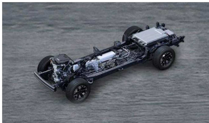
Усиленная рамная платформа Dongfeng-Nissan
