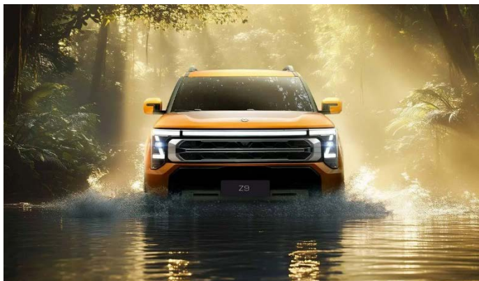
Глубина преодолеваемого брода 800 мм
