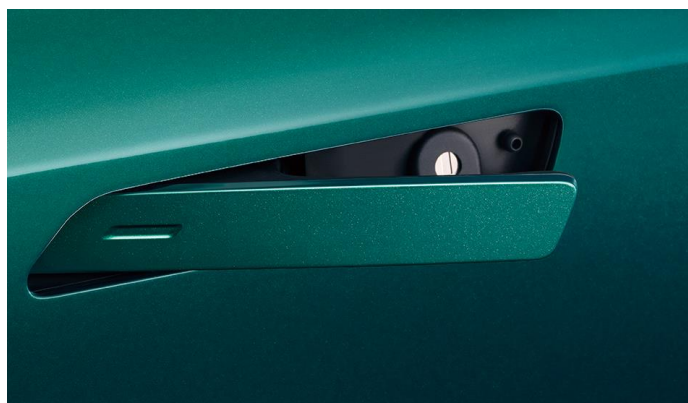
Скрытые выдвижные ручки для улучшения аэродинамики
