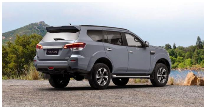
32° угол въезда / 27° угол съезда / 243 мм дорожный просвет
