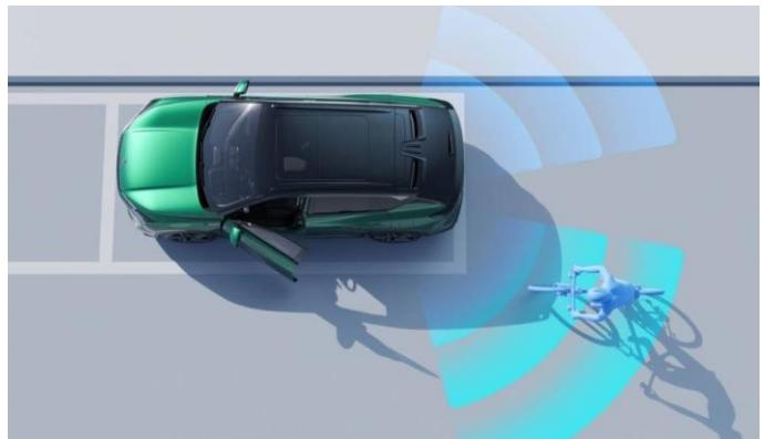
Система кругового обзора AVM 360° с функцией «прозрачного шасси»
