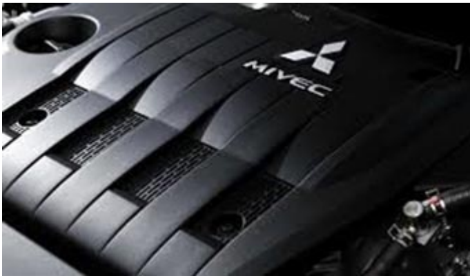
Турбированный двигатель Mitsubishi 4A95TD мощностью 197 л.с.
