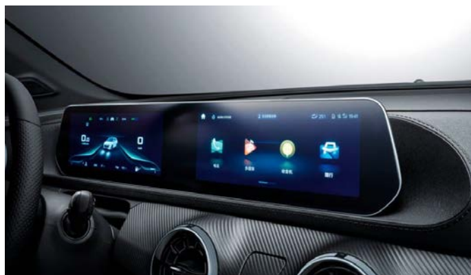
4K дисплей, состоящий из 2-х экранов с диагональю 10,25"
