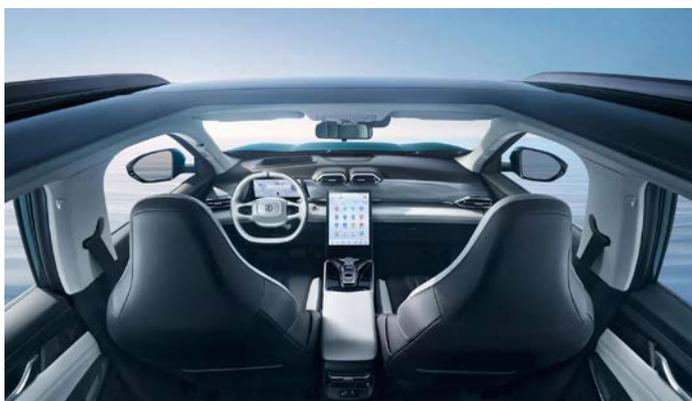
Панорамная крыша SkyLight с электролюком площадью 1,08 м<sup>2</sup>
