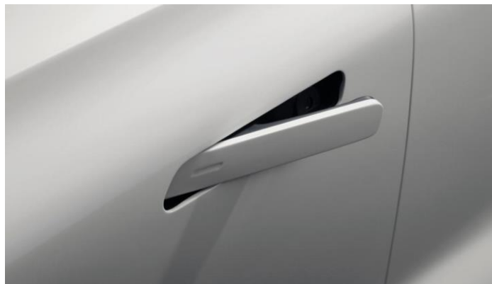
Выдвижные наружные ручки дверей, для лучшей аэродинамики
