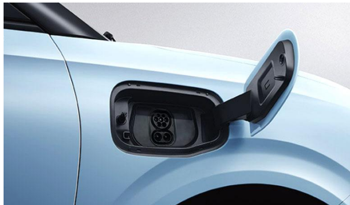
Зарядный порт CCS Combo со скоростью зарядки с 30 до 80% за 30 минут
