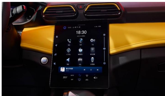
Русифицированная мультимедийная система WindLink с экраном 13" ULTRA HD планшетного типа
