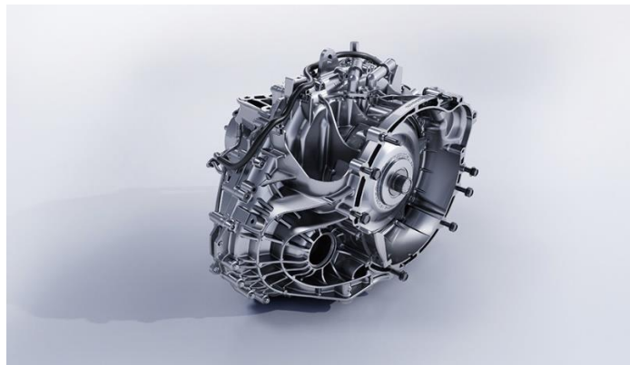
Автоматическая коробка передач DCT6 производства Getrag
