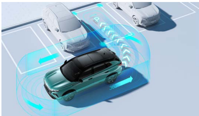
Система кругового обзора ultra-HD AVM 560 0 «Прозрачное шасси»
