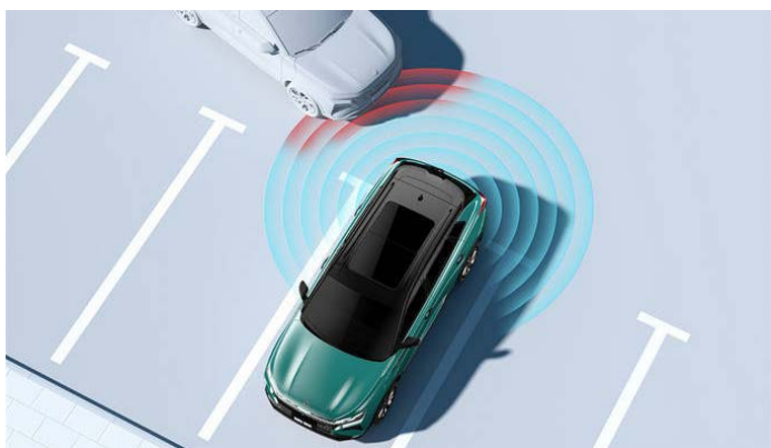
Система предупреждение об опасности столкновения сзади (RCTA)
