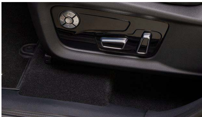
Электрорегулировка сиденья водителя в 8 направлениях
