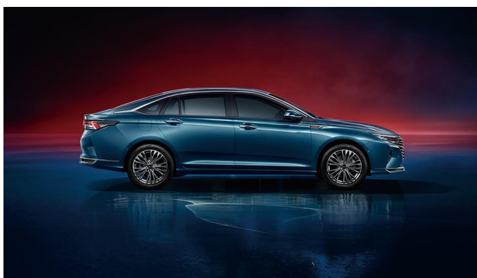
Угол наклона передней стойки 17,7° для отличной аэродинамики
