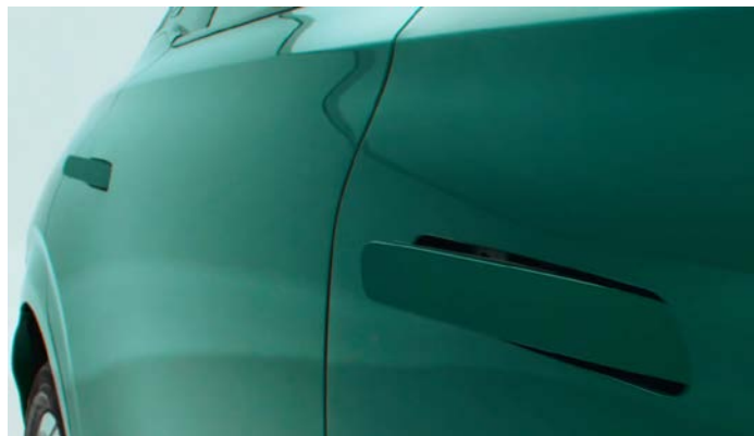
Выдвижные наружные ручки дверей, для лучшей аэродинамики
