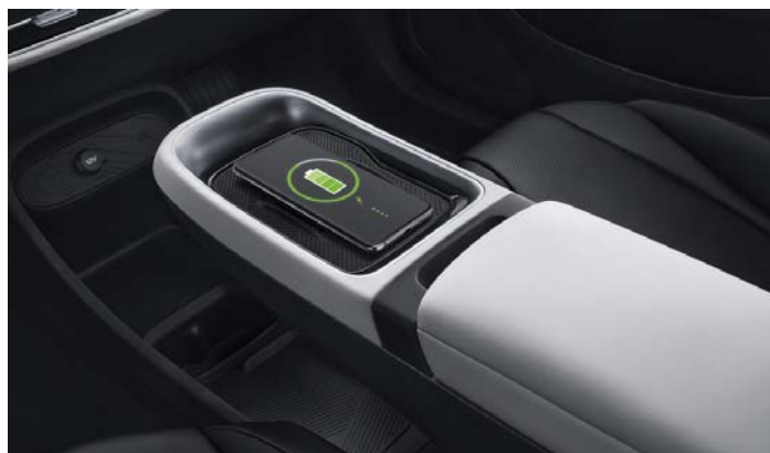
Беспроводная зарядка для смартфона с дополнительной вентиляцией
