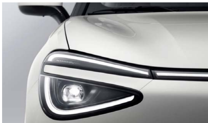
LED-оптика с системой автопереключения ближнего-дальнего света
