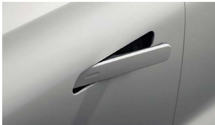
Выдвижные наружные ручки дверей, для лучшей аэродинамики
